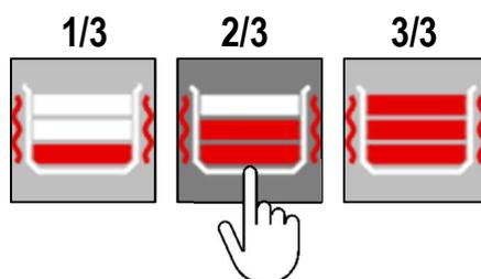
**Attention:** pour éviter des brûlures de surface du produit, sélectionnez le nombre correct de bandes en fonction du produit présent dans la cuve.
