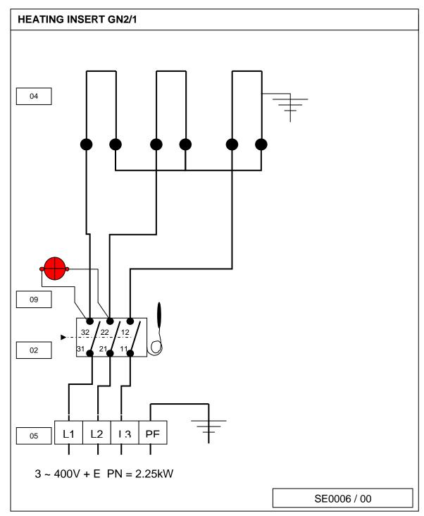
PARTS LIST: Heating Insert GN2/1 (Diagram SE0006 / 00)
