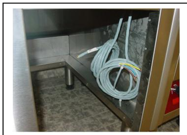
L'appareil est livré avec des câbles haute température souples situés à coté du filtre à huile ou dans le placard.
