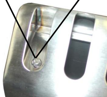
Placer la mitre au-dessus de son logement, glisser les pattes de fixation sous le dessus, et repositionner les pattes en agissant sur les vis citées ci dessus. (fig.2)
