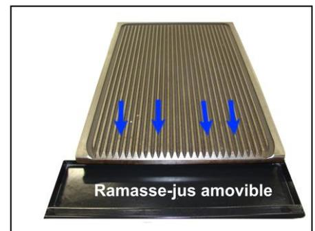
Pour cela mettre en chauffe la plaque en sélectionnant une première température (environ 100°C) durant environ 10 minutes, puis porter le thermostat sur sa position maxi durant de nouveau 10 minutes, ceci brûlera l'huile de protection.
