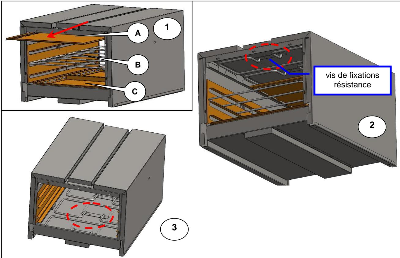
**Dépose résistance four électrique :**
