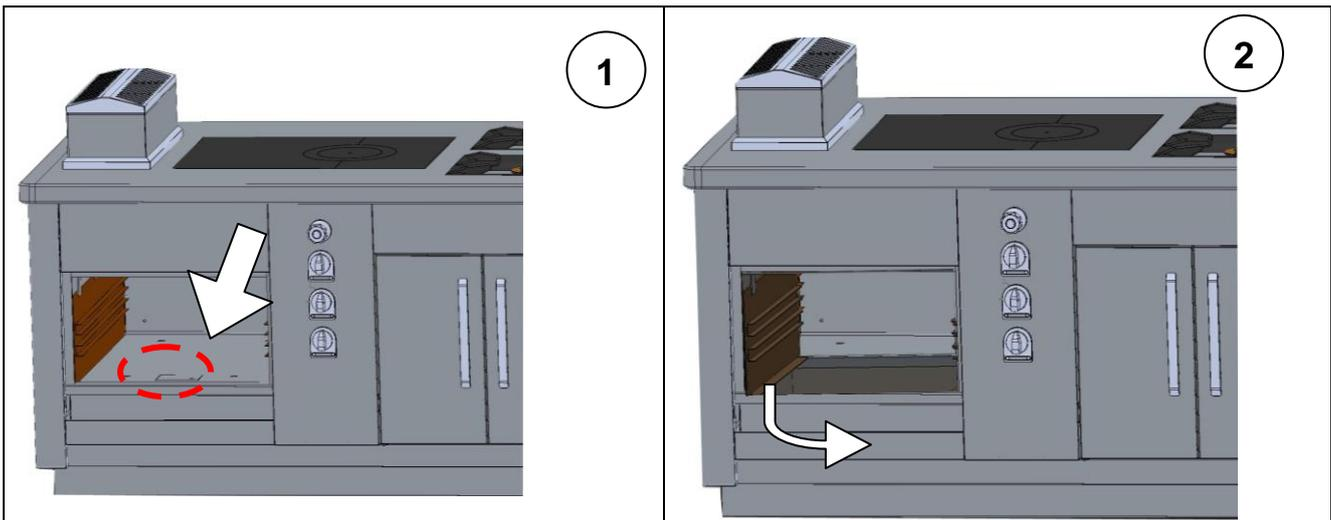
Procédure dépose, repose sole et paraboles
